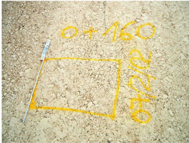
Bild 3 + 4: Kennzeichnung der Probenahmestelle und Materialentnahme an verdichteter Tragschicht ohne Bindemittel (fertige Leistung) aus Jurakalkstein.
