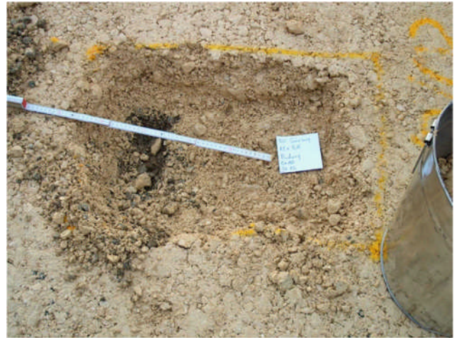
Bild 3 + 4: Kennzeichnung der Probenahmestelle und Materialentnahme an verdichteter Tragschicht ohne Bindemittel (fertige Leistung) aus Jurakalkstein.
